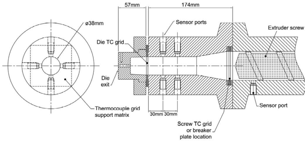
Figure 1 Instrumented extruder die
